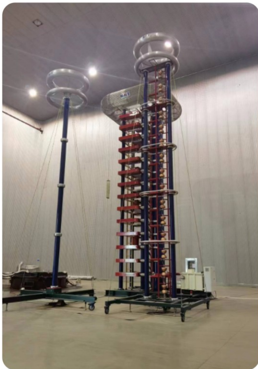
2800kV雷电冲击试验装置
