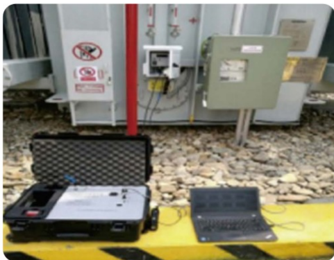
监测端子箱及便携式避雷器绝缘检测设备
