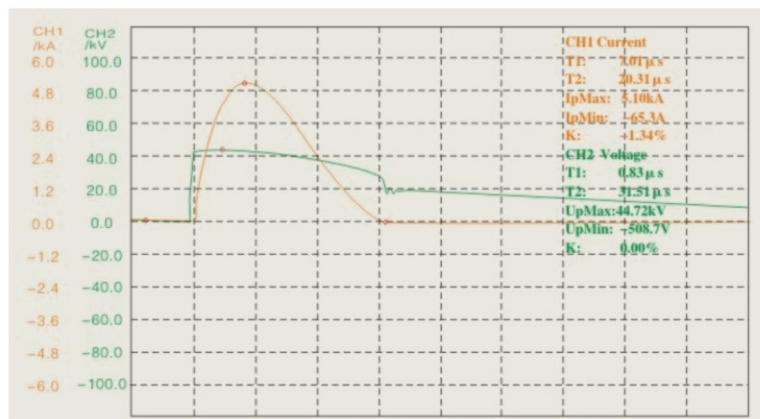
普通保护系统对过电压限制幅值
